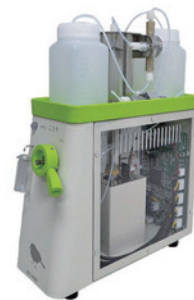
教育用の小型高速液体クロマトグラフ「e-HPLC ことり」
